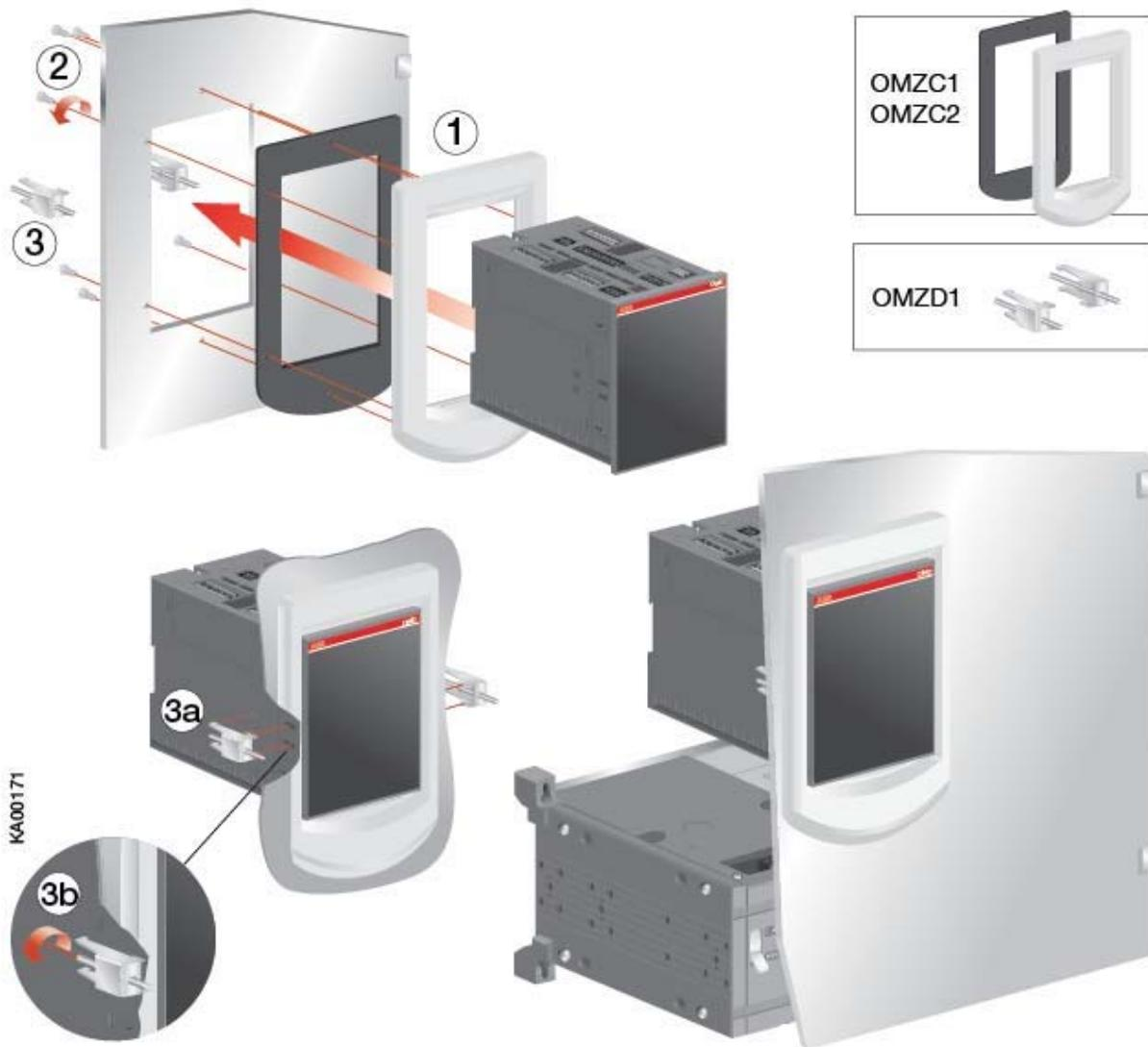
Рисунок 5.40 Блок автоматического управления OMD\_, монтаж в двери вместе с защитной панелью, отверстия в двери для установки защитной панели OMZC\_, см. аксессуары, рисунок 14.10, страница 100
