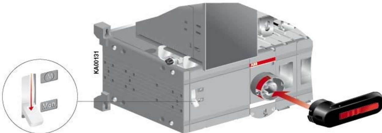
Рисунок 4.9 Ручное управление выключателем нагрузки
