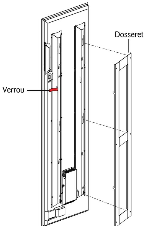
Soulever l'appareil, l'enclencher sur le côté gauche du dossieret. Faire pivoter l'appareil sur la droite, soulever le verrou.
