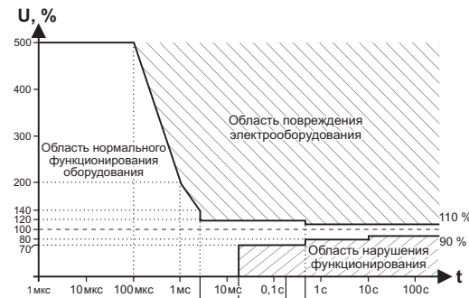
Рисунок 1. Кривая работы электрооборудования ITIC (CBEMA), ( http://www.home.agilent.com/upload/cm_upload/All/1.pdf?cc=UA&lc=eng ).
