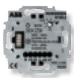
Interruptor temporizado de 2 relés | 8130.2 | 230 V~ ; 50 Hz<br>127 V~ ; 60 Hz<br>2 x 700 W / VA ; 3 AX a 230 Vac<br>Válido para todo tipo de cargas. Con fluorescentes usar contactores.<br>Temporizador: 30 - 300 seg.<br>Bornas de conexión de pulsadores (8104.X)<br>Teclas ref. 8530 |
