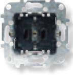
Bipolar con TT lateral Schuko conexión automática | 8188.6 | 16 A ; 250 V~<br>Proteccion contra contactos directos involuntarios.<br>Conexion tipo "borne sin tornillos". Reduce los tiempos de instalacion en un 40%.<br>Tapa ref. 8588 |
