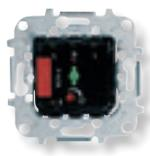
Interruptor temporizado de relé   | 8162   | 230 V~ ; 50 Hz<br>Temporización de 10 seg. a 10 min.<br>☉ 1000 W<br>☐ 1000 VA cos φ = 0,6<br>☒ 650 VA<br>Para fluorescentes.<br>Protección fusible T5 A.<br>Con borna de control remoto para pulsadores convencionales (8104.5) y led de orientación.<br>Tecla ref. 8562 |
