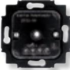
Regulador electrónico giratorio 1-10 VDC                             | 8160.9  | 230 V~ ; 50 Hz.<br>Válido para fluorescentes con balasto electrónico regulable.<br>Potencia: 700 W / VA<br>Tensión de control:<br>1 - 10 V DC<br>Corriente max. de control del balasto: 50 mA DC.<br>Tapa ref. 8560.2                        |
