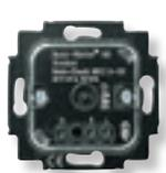
Interruptor - relé de empotrar      | 8141.4 | 230 V~ ; 50 Hz<br>☉ ☐ ☒ ☐<br>Válido para todo tipo de cargas<br>Potencia: 700 W / VA<br>Conexión a 3 hilos<br>Para sensor 8541.1                                           |
