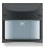
Sensor detector | 8541.1 | BL<br>PL<br>NS<br>AI<br>Angulo de detección 180°<br>Alcance frontal 12 m.<br>Alcance lateral 8 m.<br>Margen de desconexión ajustable entre 2 s. y 32 min.<br>Umbral de iluminación entre 5 a 1000 Lux.<br>Para interruptores ref. 8141.3 y 8141.4 |
